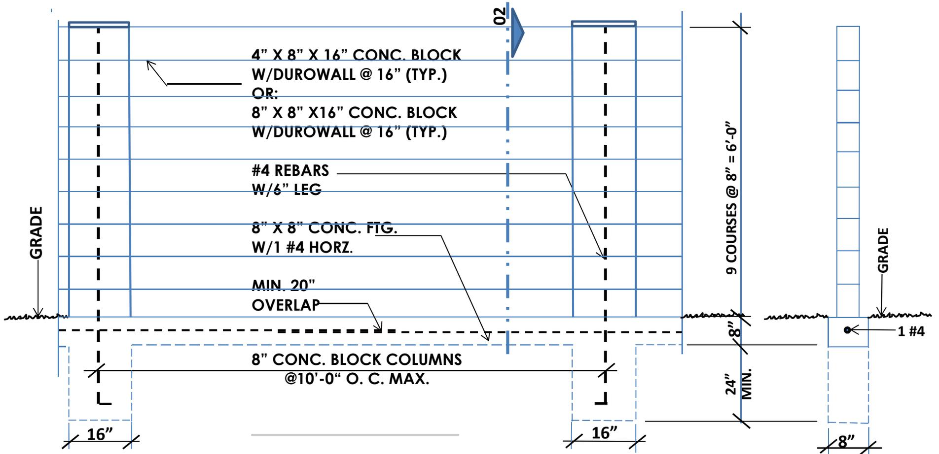
01 MASONRY FENCE ELEVATION
